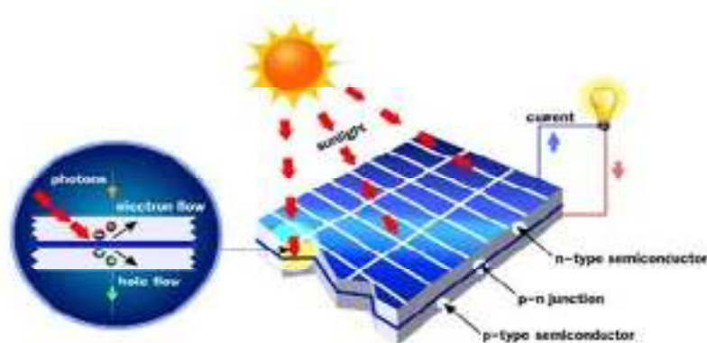
Gambar 2.10 Skema Sel Surya
