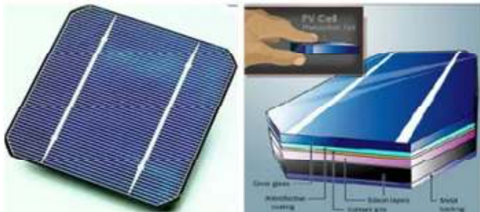
Gambar 2.10.: Struktur Panel surya
