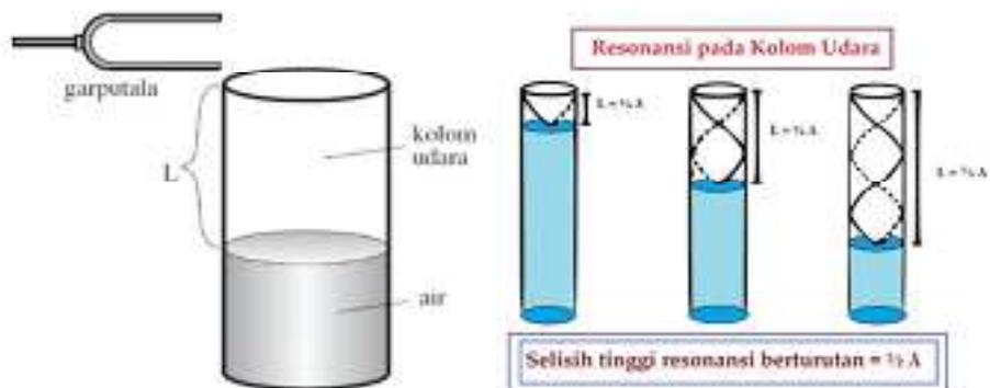
Gambar 2. 14 Resonansi kolom udara
