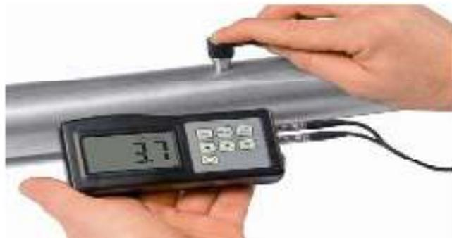
Gambar 2. 20 Aplikasi pemantulan bunyi mengukur ketebalan logam
