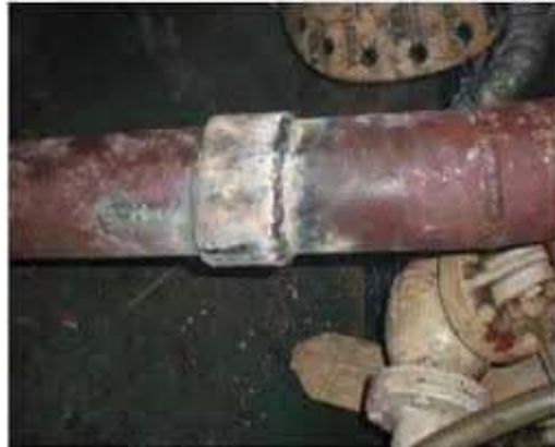
Gambar 2. 5 Korosi galvanik (Sumber : Utomo, 2009)
