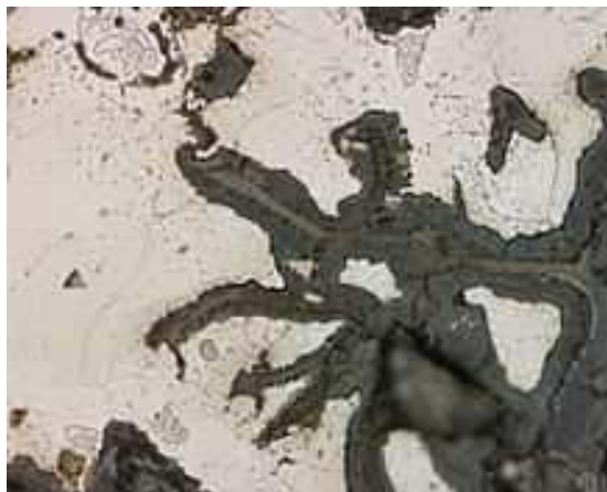
Gambar 2. 9 Selective leaching corrosion pada pipa (Sumber: Jaya, dkk, 2010)
