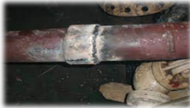
Gambar 2.3 Korosi Galvanik (Sumber utomo,2009)
