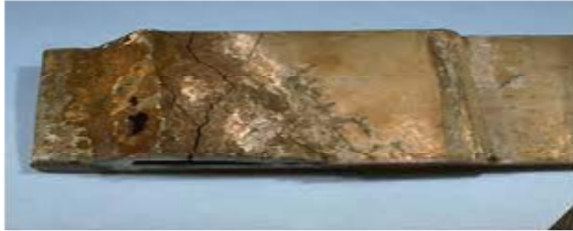
Gambar 2.7. Korosi retak (Sumber google)
