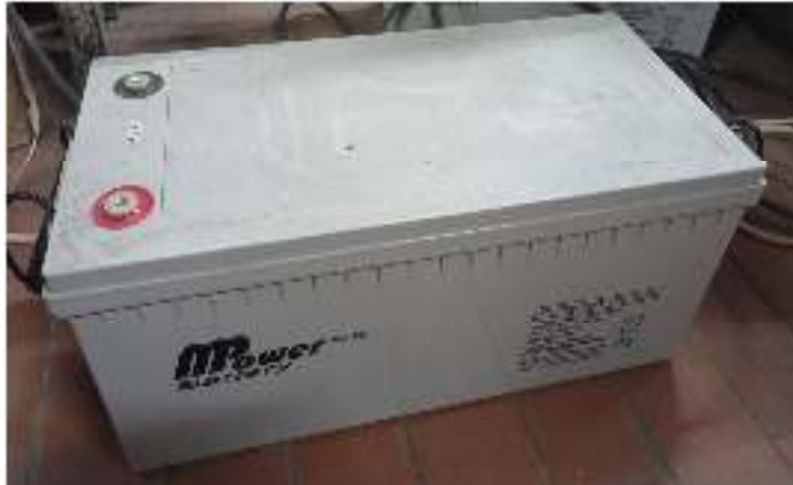
Gambar 2.10 Baterai Lithium 24 volt
