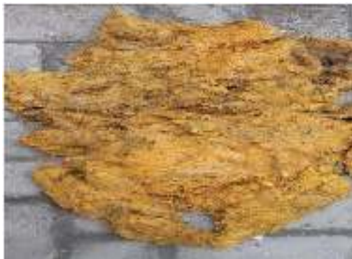
Gambar 3.15. Daging Kelapa sawit yang sudah digester
