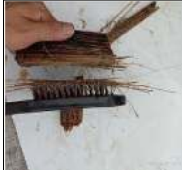
Gambar 3.20 Memisahkan Serat dengan Sisir Besi
