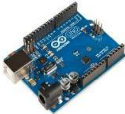
Gambar 2.2. Arduino uno Berbasis mikrokontroler ATmega328p
