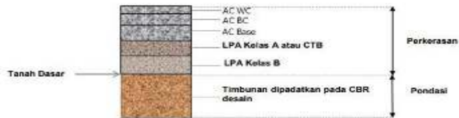
Gambar 2. 3 Struktur Perkerasan Lentur (Lalu Lintas Berat) pada galian
