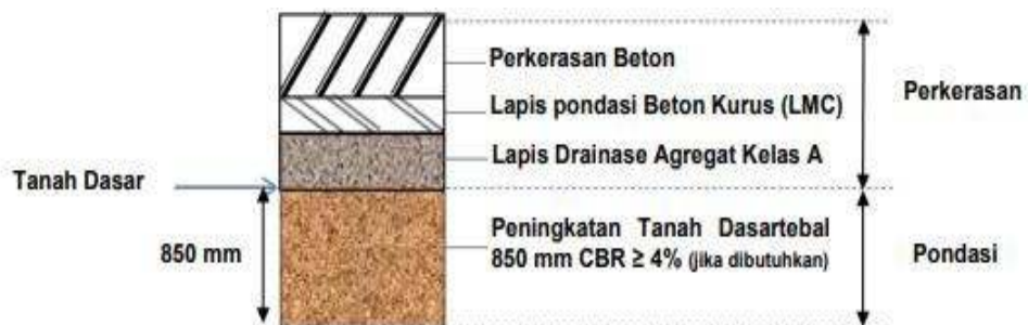
Gambar 2. 4 Stuktur Perkerasan Kaku Pada Galian
