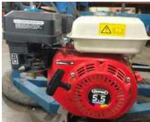
**Gambar 3.4 Mesin Motor Bensin**
