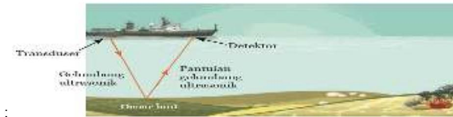
**Gambar 2. 19 Contoh Sonar yang digunakan untuk nelayan**
