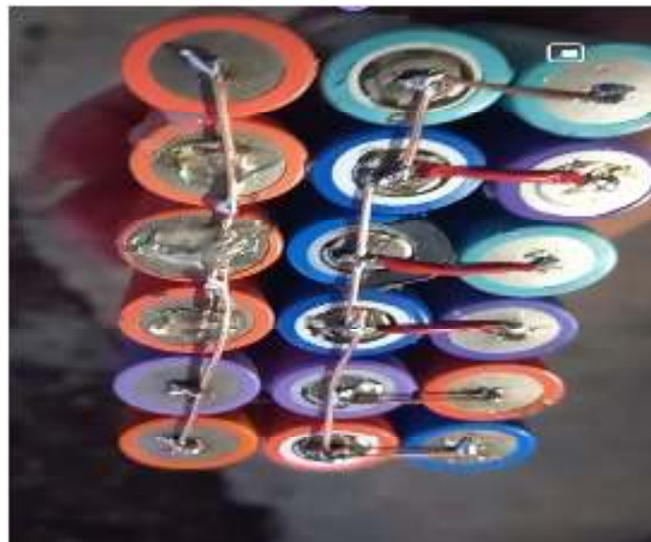
Gambar 3.21 Desain Baterai susunan seri dan paralel
