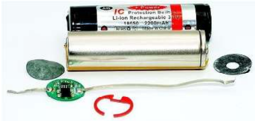
Gambar 2. 3 Proteksi Baterai Li-Ion 18650
