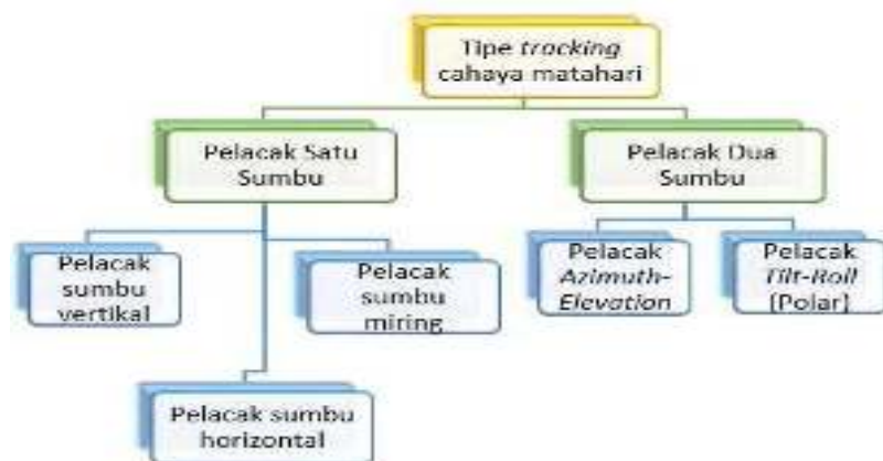
Gambar2.7 :Tipe solar tracking berdasarkan sumbu putaran
