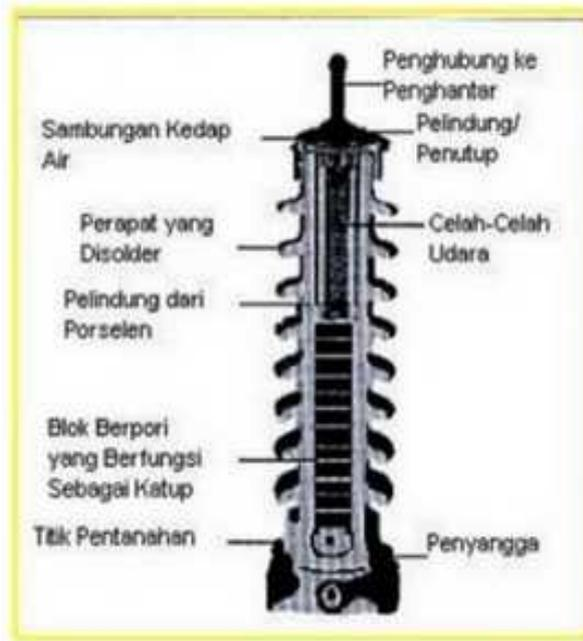
Gambar2.5. Konstruksi sebuah lightning arrester buatan Westinghouse yang menggunakan Celah udara (air gap) diatas
