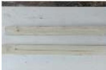
Gambar 3.11 Cetakan silikon spesimen uji bending
