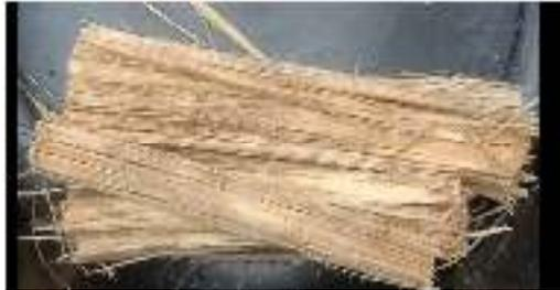
Gambar 3.22 Proses pelunakan pelepah kelapa sawit
