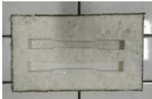
Gambar 3.10 Cetakan silikon spesimen uji Tarik
