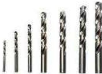
Mata bor merupakan suatu alat yang digunakan untuk melubangi bahan-bahan yang berbeda-beda seperti kayu, plastik, dinding, besi, logam dan kaca. Banyak sekali jenis dan ukuran lubang yang dapat dibuat dengan mesin bor, beda jenis beda pula fungsinya. Maka dari itu kita perlu menggunakan mata bor yang sesuai dengan bahan yang akan dilubangi.
