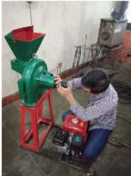
**Gambar 3.16 Pemasangan *Pulley* yang digerakkan untuk 3 Inchi**
