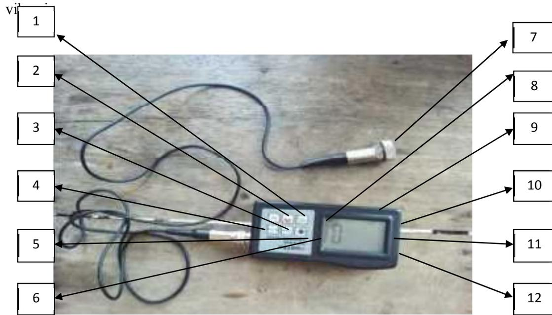
**Gambar 3.2 Vibrometer**
