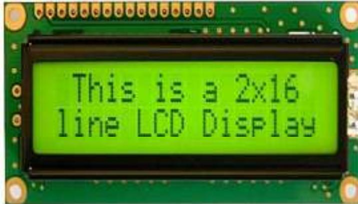
Gambar 2.5. Bentuk fisik LCD 2 x 16
