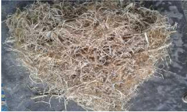
Gambar 3.1 Serat batang kelapa sawit
