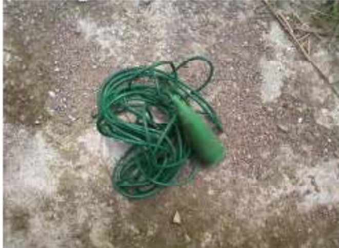
Gambar 3.1 Kabel penghubung elektroda batang
