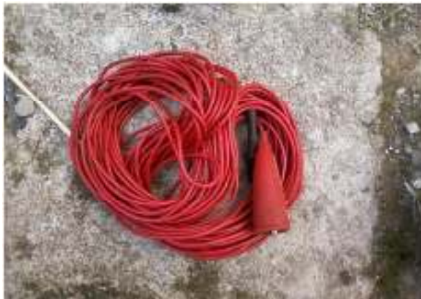
Gambar 3.2 Kabel penghubung elektroda bantu 1
