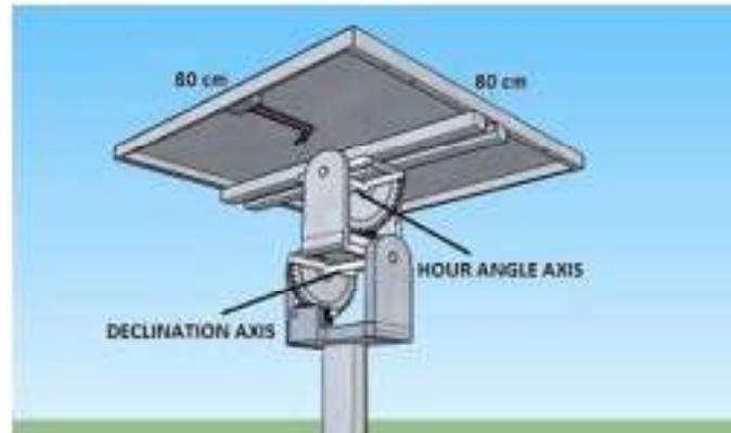
Gambar 2.10 : Rangka *Double Axis* (Dua Sumbu)
