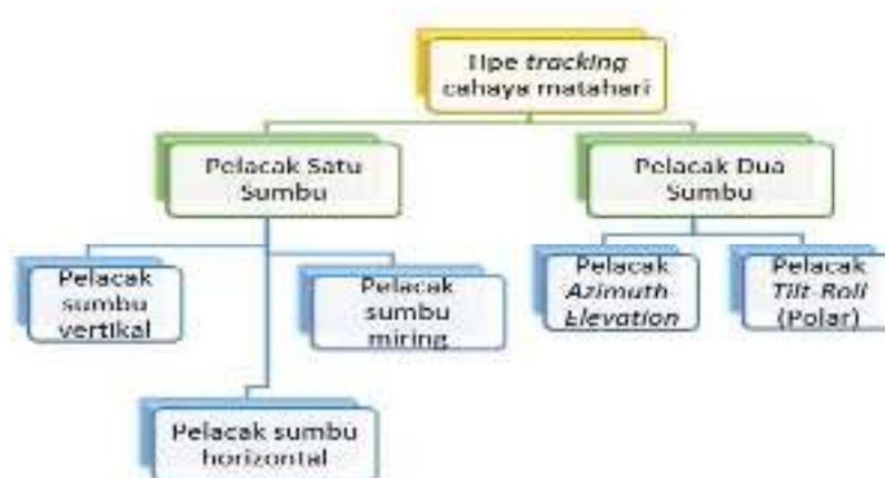
Gambar 2.7 : Tipe *solartracking* berdasarkan sumbu putaran
