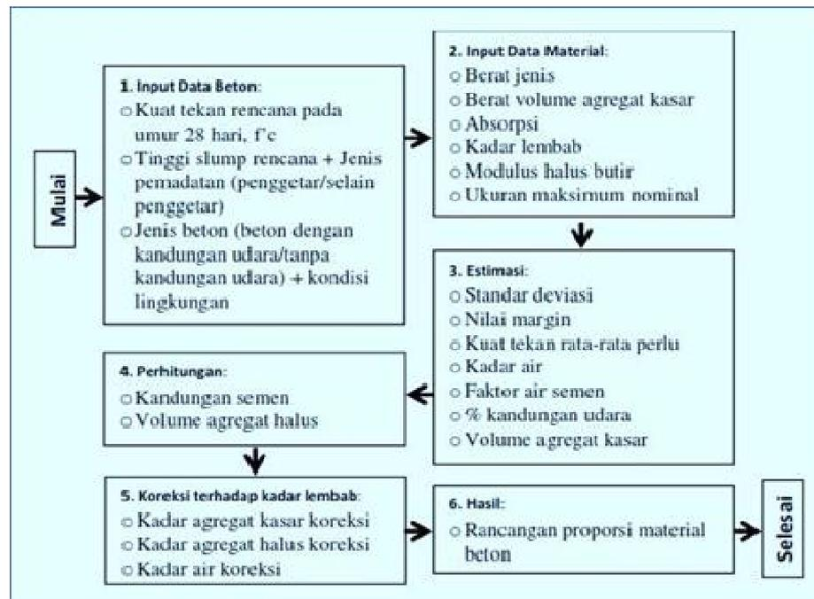
**Gambar 2. 12** Prosedur perancangan campuran beton menurut 7656:2012
