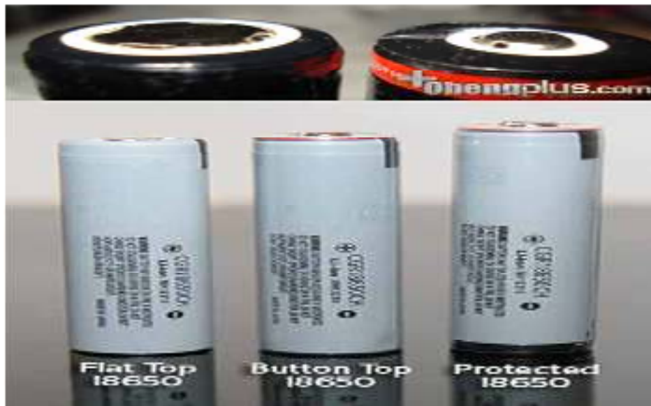
Gambar 2. 8 Proteksi baterai lithium
