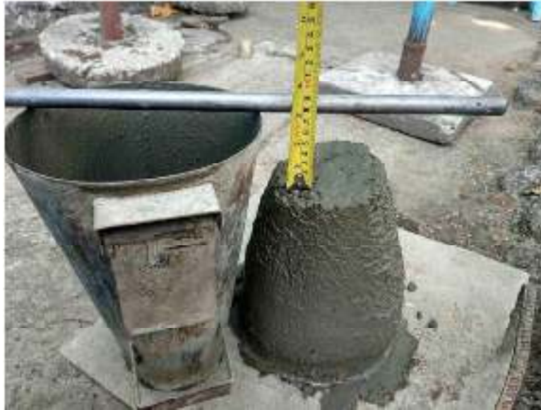
Gambar 2. 6 Pengujian Slump Test
