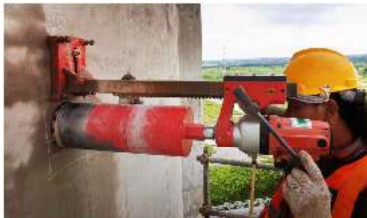
Gambar 2. 8 Alat pengujian Core Drill
