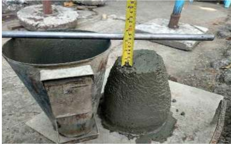
Gambar 2.5 Pengujian Slump Test
