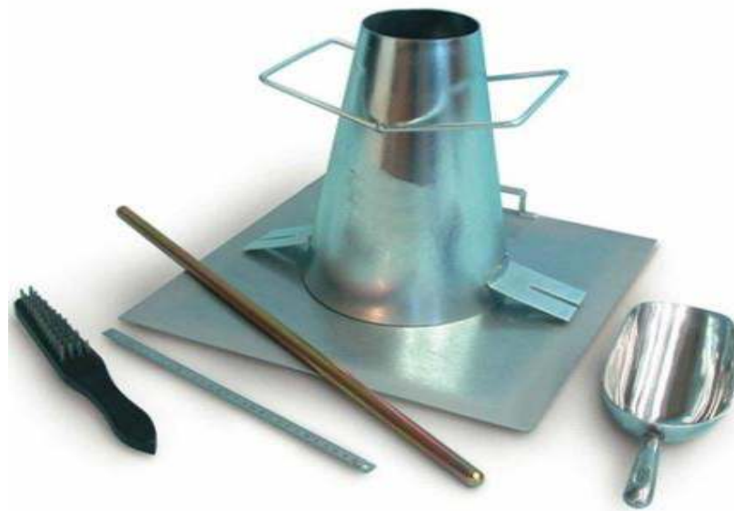
Gambar 2.4 Alat Uji Slump Tes
