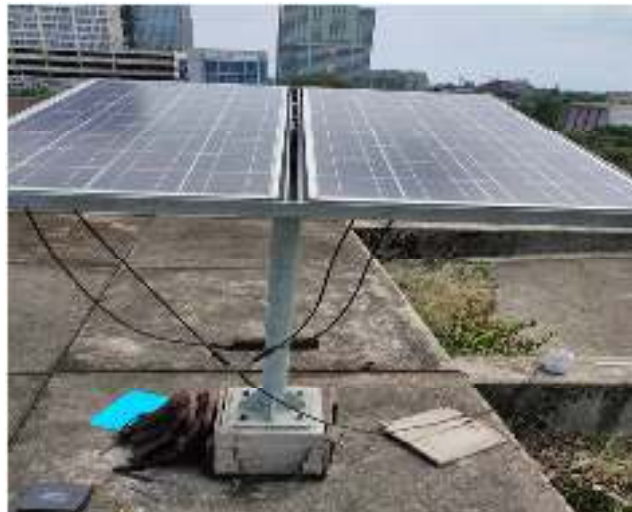
Gambar 3. 2 Dua buah panel surya seri
