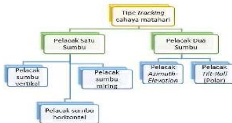
Gambar2.7 : Tipe solar tracking berdasarkan sumbu putaran
