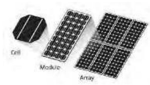
Gambar 2.4 Perbedaan cell , module dan array .
