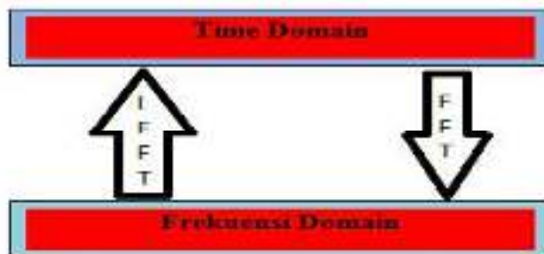
Gambar 2.2 Hubungan Data Time Domain dengan Frekuensi Domain
