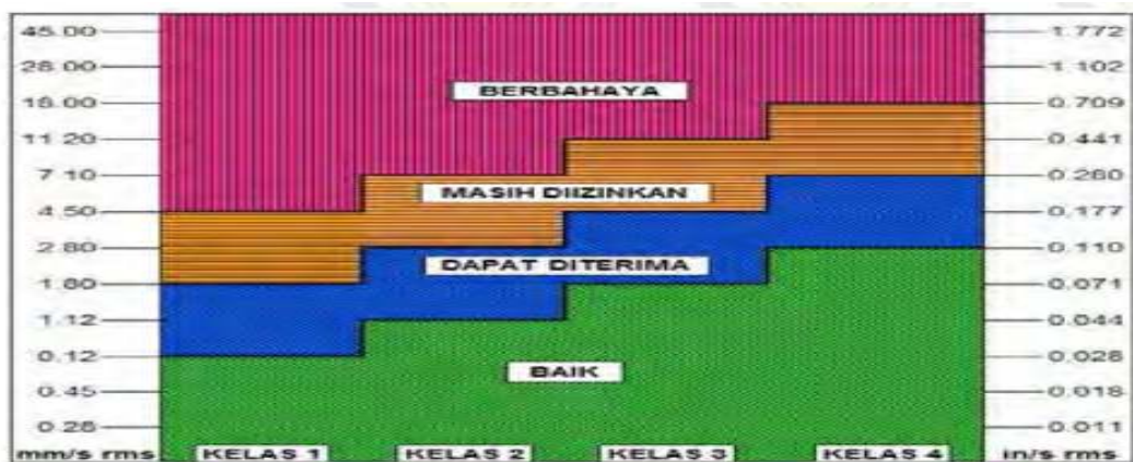
Gambar 1. Standar Vibrasi Motor ISO-10816-1
