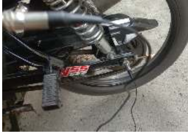
Gambar 3.10 Titik pengukuran secara Longitudinal
