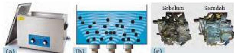
Gambar 2.11 (a) Alat Pembersih Ultrasonik, (b) Gelombang dan Gelembung dalam Pembersih Ultrasonik, (c) Mesin yang Dibersihkan dengan Alat Pembersih Ultrasonik
