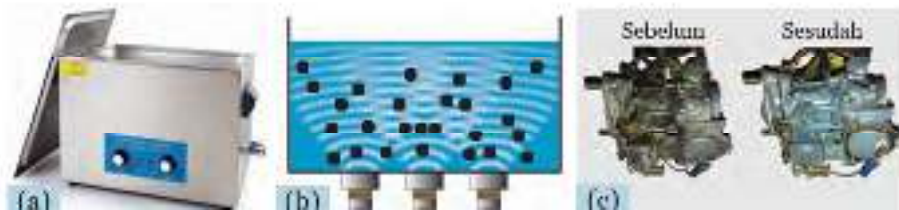
Gambar 2.9 (a) Alat Pembersih Ultrasonik, (b) Gelombang dan Gelembung dalam Pembersih Ultrasonik, (c) Mesin yang Dibersihkan dengan Alat Pembersih Ultrasonik.
