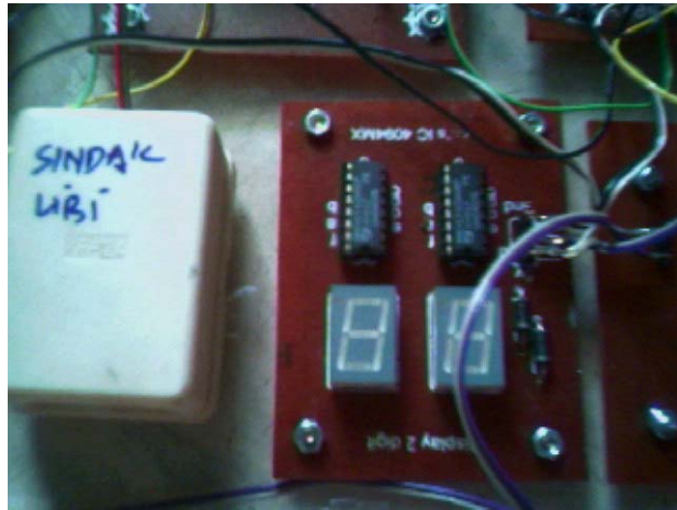
Foto Rangkaian Display Nomor urutan Lampu Yang sedang di akses
