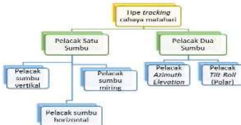
Gambar 2.7 : Tipe solar tracking berdasarkan sumbu putaran
