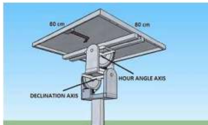
Gambar 2.10 : Rangka Double Axis (Dua Sumbu)
