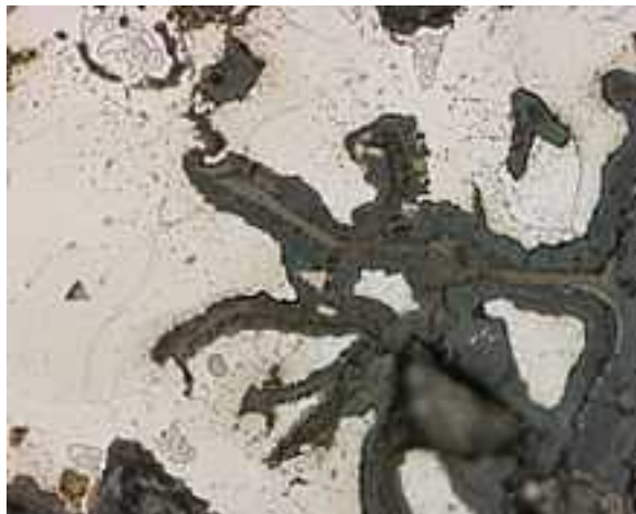
Gambar 2.8 Selective leaching corrosion pada pipa (Sumber : Jaya, dkk, 2010)
