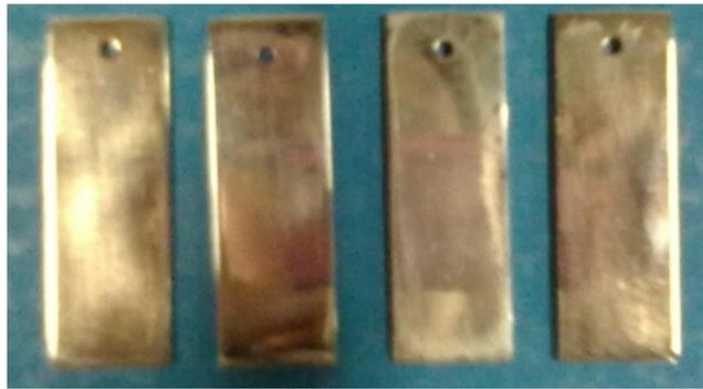
Gambar 3.5.: Hasil elektroplating nikel terhadap spesimen
