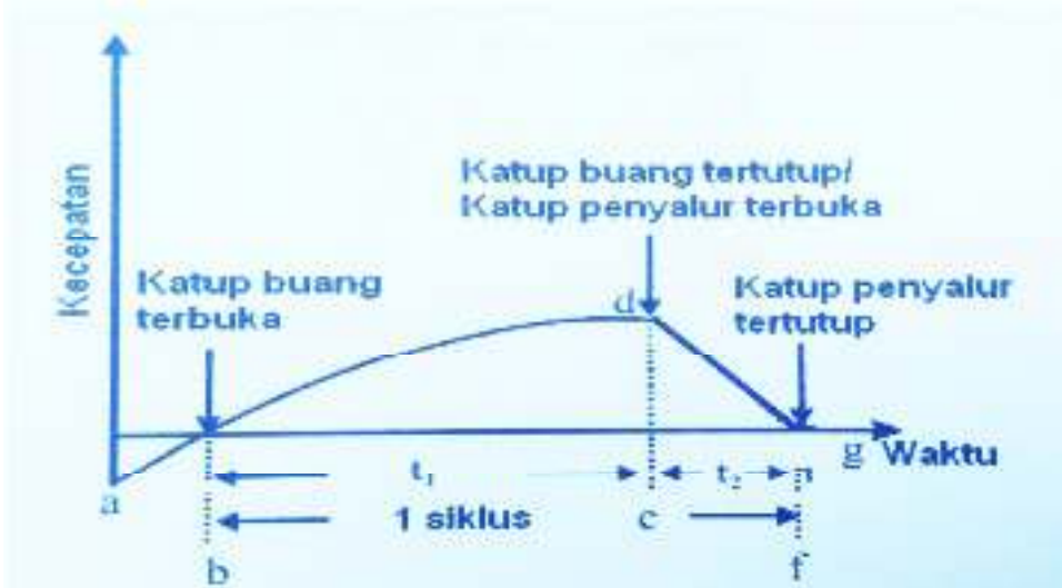
Gambar 2.3. Grafik waktu - kecepatan pada pompa hydram (taye 1998)
