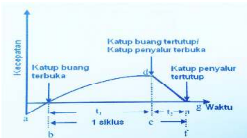
Gambar 2.3. Grafik waktu - kecepatan pada pompa hydram (taye 1998)
