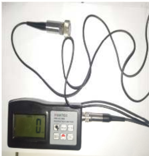
Gambar 3.2 Vibrometer Handheld dan keterangannya
