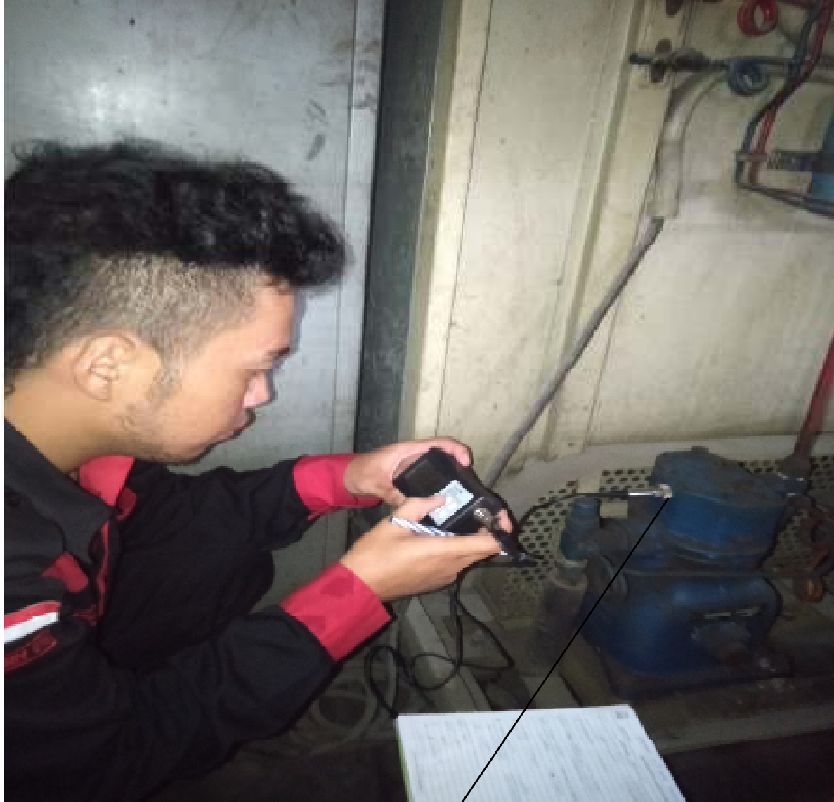
Gambar 3.10 Titik pengukuran secara Longitudinal.
