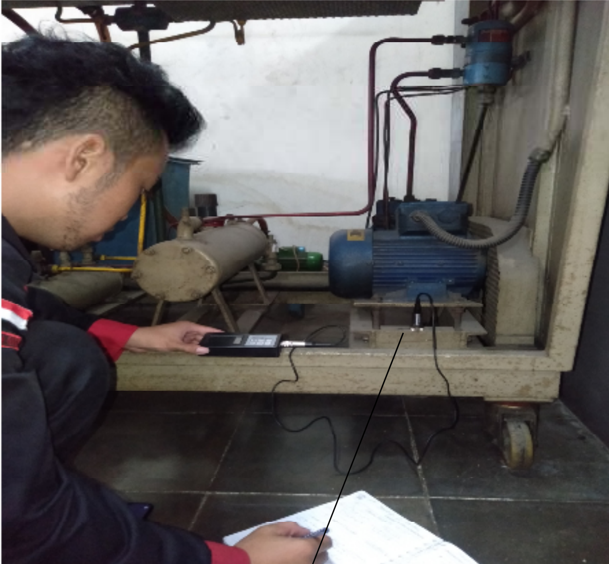
Gambar 3.5 Titik pengukuran secara Vertikal.
