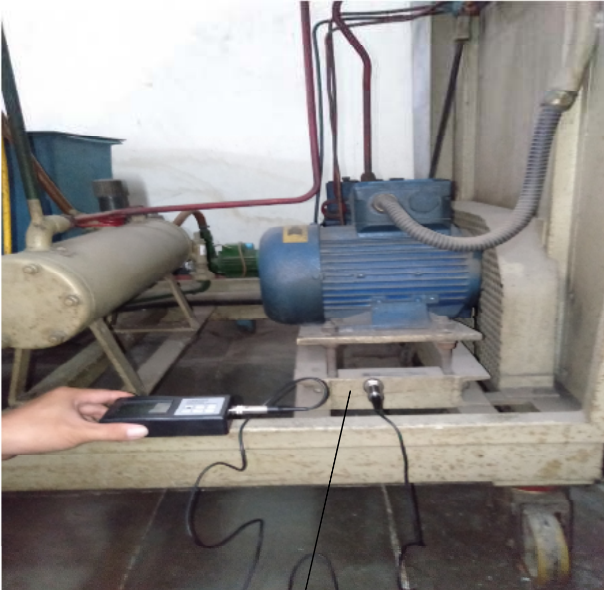
Gambar 3.6 Titik pengukuran secara Longitudinal.
