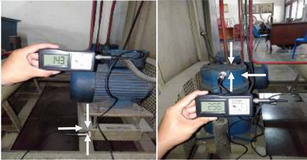
Pengukuran Displacement di landasan. Pengukuran Displacement di kompresor.
