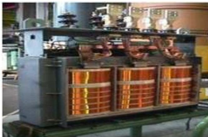
Gambar 2.11 Kumparan Transformator
