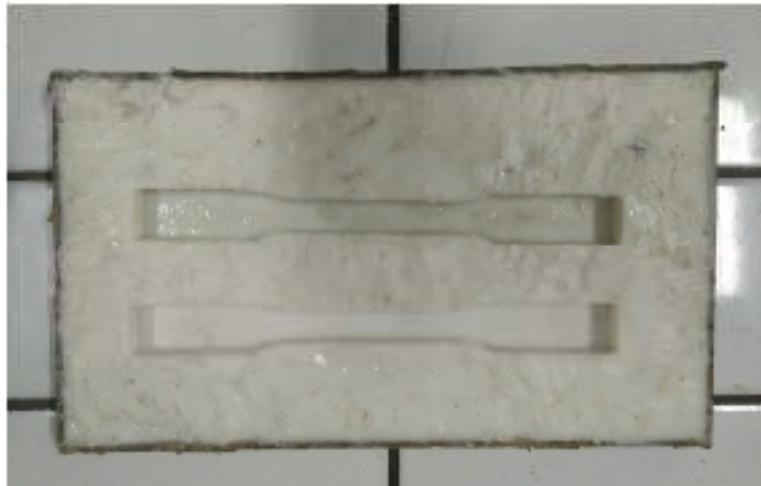
**Gambar 3.6.** Cetakan Karet Spesimen Uji Tarik (*Silica Rubber + Hardener*)
