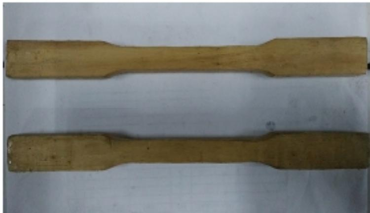
**Gambar 3.2. Pola spesimen uji tarik terbuat dari kayu.**
