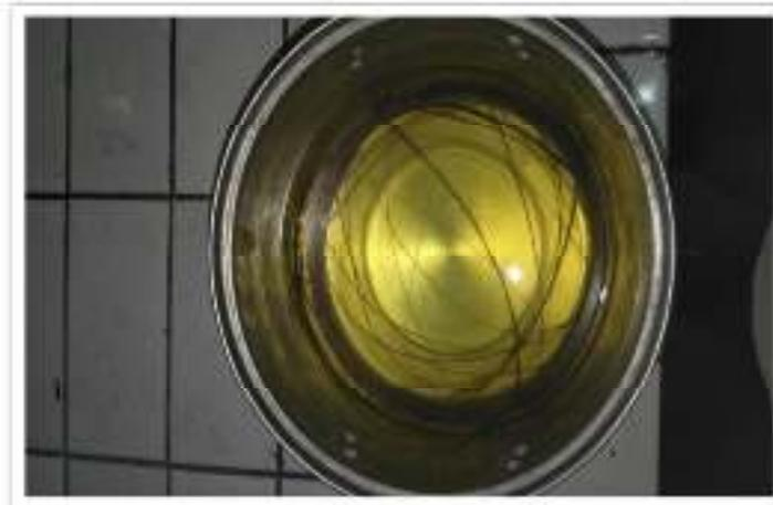
**Gambar 3.20. bambu di rendam dengan NaOH.**
