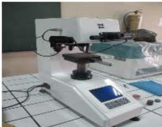
**Gambar 3.10. Alat Uji Kekerasan**
