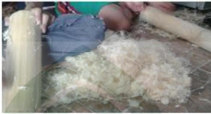
**Gambar 3.18. Proses pengambilan serat bambu**
