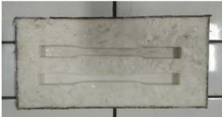
Gbr 3.6 Cetakan Karet Spesimen Uji Tarik ( Silica Rubber + Hardener )
