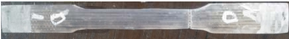
Gambar 3.18 komposit serat variasi lurus
