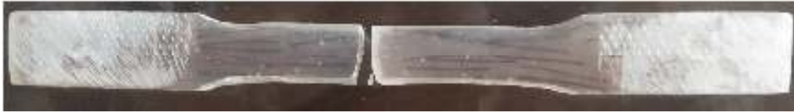
Gambar 3.19 komposit serat pohon aren (ijuk) variasi discontinious
