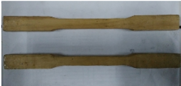
Gambar 3.2 Pola Spesimen Terbuat Dari Kayu
