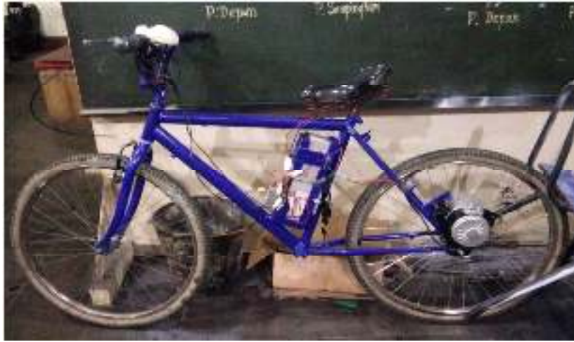
Gambar 3.2. Sepeda Ontel yang Dirancang menjadi Sepeda Listrik
