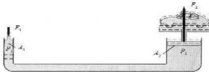
**Gambar 2.4. Dongkrak Hidrolik**
