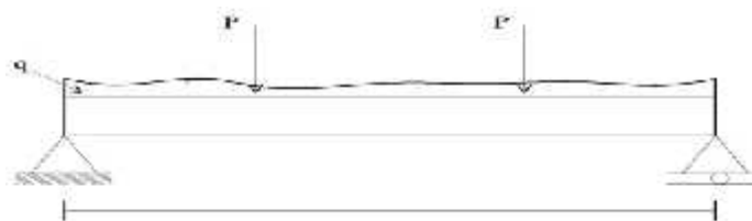
Gambar 2.1.(a) balok dengan beban P dan q .
