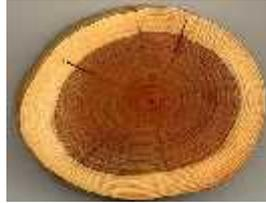
Gambar 2.2. Penampang Melintang Batang Kelapa Sawit
