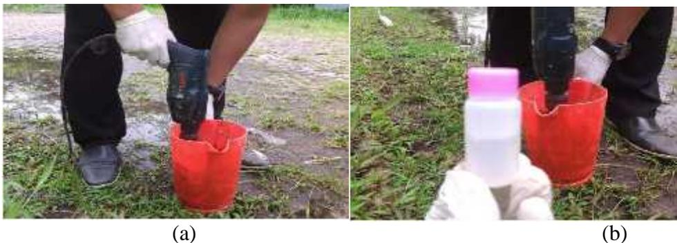
Gambar 4.9 (a) Proses pengadukan campuran serat batang kelapa sawit dengan resin (b) Katalis untuk mempercepat proses pengerasan campuran resin
