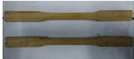
Gambar 3.3. Pola Spesimen dari Kayu
