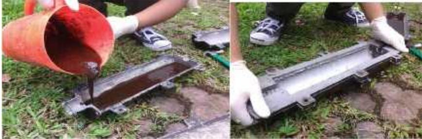
Gambar 4.10 Proses penuangan campuran komposit pada cavity dan menutup cetakan
