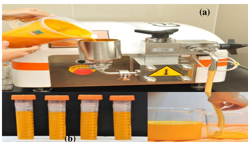
Gambar 5. Nanoemulsi minyak sawit limbah PKS: proses pembuatan (a) dan produk yang dihasilkan (b)
