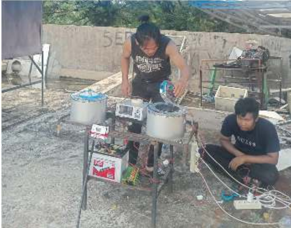
Gambar 3.19 Menyiapkan Data Logger dan Memasang Thermokopel tipe K pada titik-titik yang telah ditentukan
