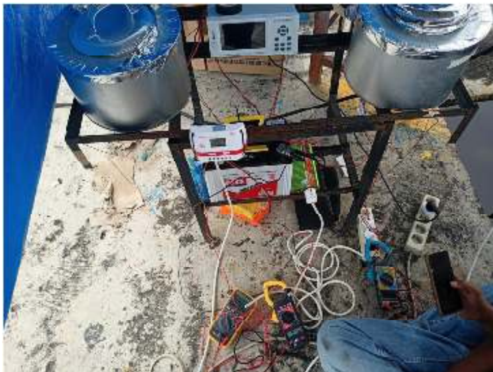
Gambar 3.27 Catat Arus DC, AC dan Ampere yang diukur dengan Tang amper dan Multimeter digital dengan setiap 1 menit menggunakan stopwatch .
