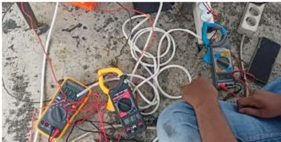
Gambar 3.20 Menyiapkan alat pengukur arus dan tegangan berupa: Tang ampere dan multimeter digital. Catat Arus DC, AC dan Ampere yang telah diukur
