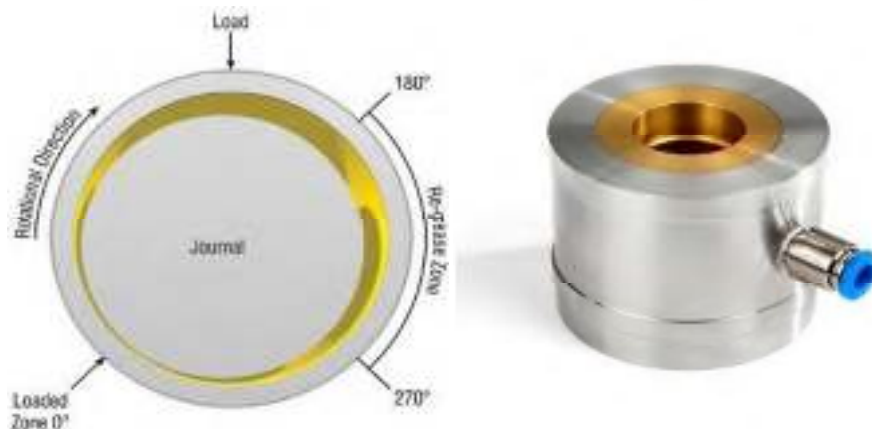
Gambar 2.5 Journal Bearing dan ketebalan minyak pelumas
