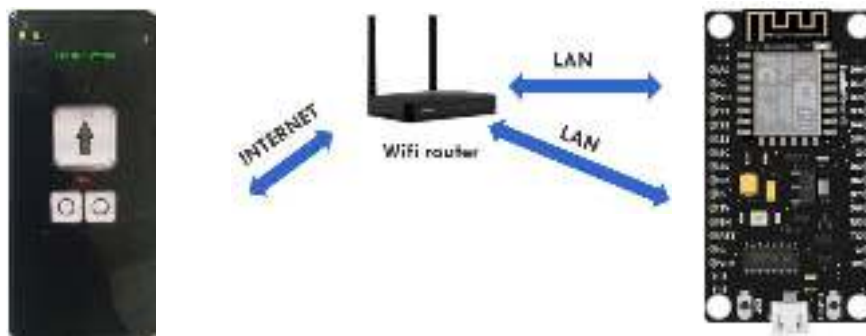
Gambar 2.11. Cara kerja Virtuino
