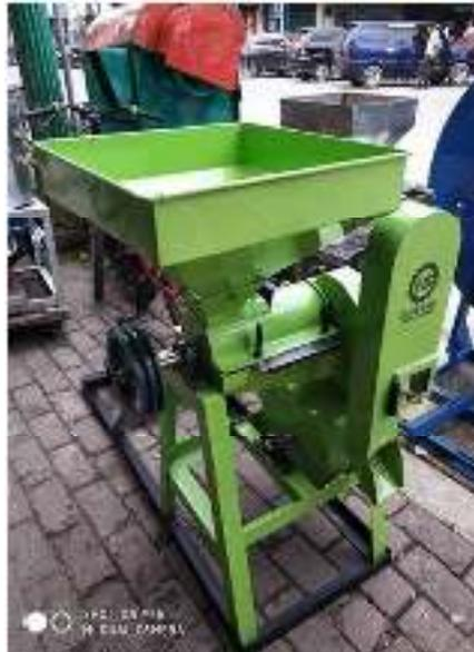
Gambar 2.2 Mesin Huller
